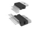
**Descrizione:** IC AMP AUDIO 7W STER MULTIWATT15 Produttori: STMicroelectronics Disponibile: Nuovo originale, pezzi di ricambio 11900
